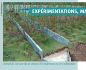
Des campagnes de mesures ont été menées pour comparer les valeurs de capacité d'infiltration, de ralentissement des écoulements et de sédimentation. Elles ont été réalisées pour 4 principaux types de BLC d'âges différents et selon des techniques d'implantation et de récolte diverses.
